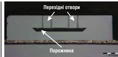
Рис. 5. Кристал резонатора з МЕМС-структурою всередині герметичної порожнини. Перехідні отвори забезпечують зв'язок резонатора із зовнішньою поверхнею кристала
