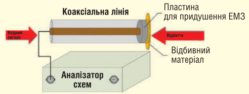
Рис. 9. Схема вимірювання загасання за допомогою коаксіальної лінії
