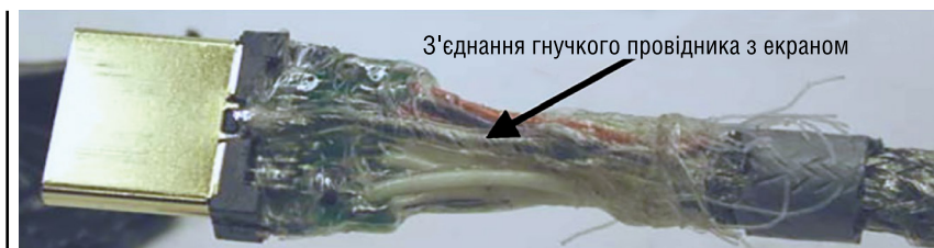
Рис. 9. Приклад поганого заправлення HDMI-кабелю
