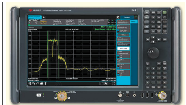
Рис. 2. Аналізатор сигналів N9041B серії UXA може працювати у міліметровому діапазоні з безперервним співуванням до 110 ГГц
