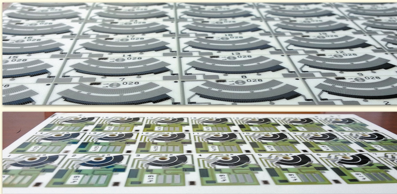
Рис. 3. Приклад керамічної друкованої плати із вбудованими компонентами
