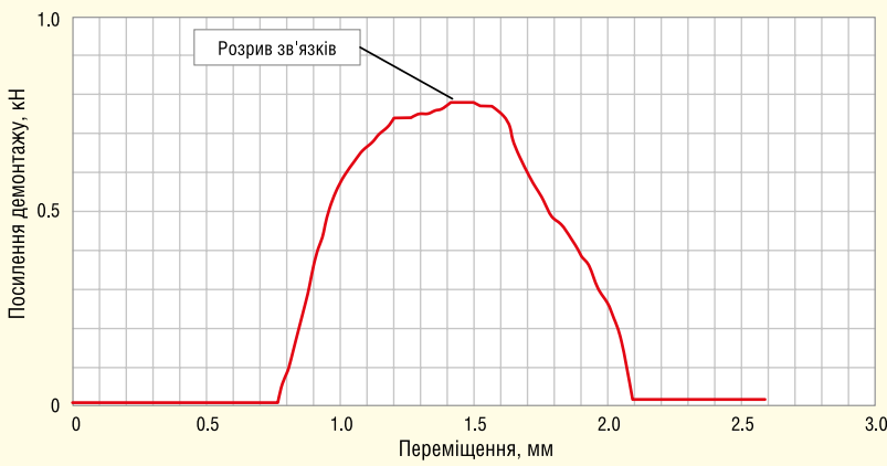
Рис. 16. Типовий профіль демонтажу для 21-вивідного модуля
