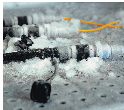
Рис. 2. ОЗ сімейства FiberOptic при випробуваннях за зниженої робочої температури
