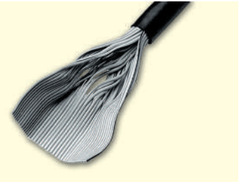
Рис. 3. Стрічковий 3М-кабель: плоский, крок 1.27 мм, багатожильний, Cu, 9 x 26 AWG, кригла ПВХ-оболонка
