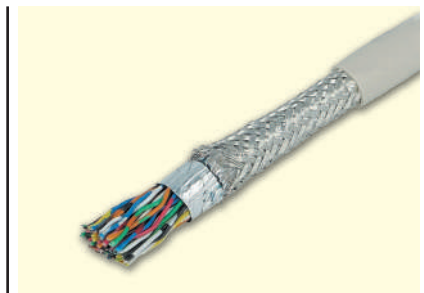
Рис. 7. Багатожильний провід 3600В-50 — кабель, 25 x 2 x 28 AWG, екранований, в ПВХ-оболонці
