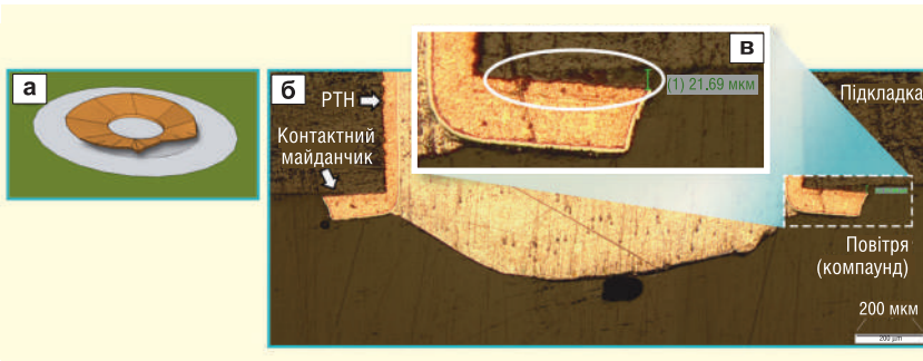
Рис. 4. Приклад підйому контактних майданчиків, який може статися при термічному навантаженні (плавлення припою при +288 °C протягом 10 с): змодельований приклад підйому майданчика (а); фото поперечного перерізу плати при підйомі майданчика (б) та збільшена область плати з дефектом (в)
