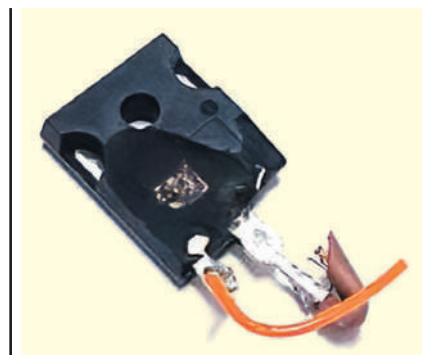
Рис. 4. Руйнування IGBT після тесту на коротке замикання
