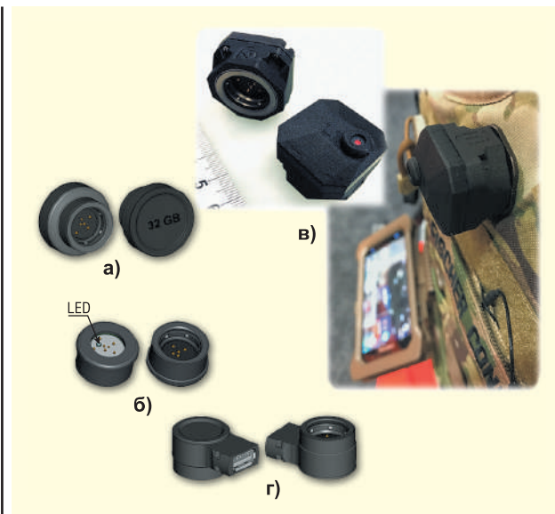
Рис. 4. Моноблочні пристрої на основі з'єднувачів Freedom для використання в екіпіровці Eleksen: флеш-накопичувачі (а); світлодіодні ліхтарі (б); адаптери інтерфейсів (в); мініатюрні USB 2.0 веб-камери (г)
