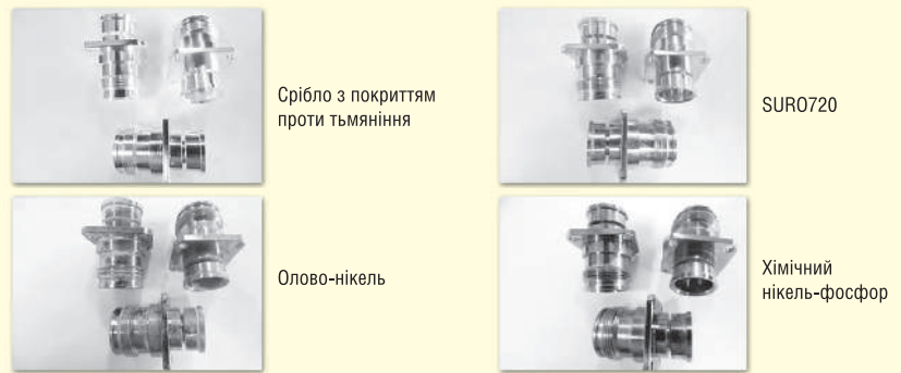
Рис. 6. Корозія зразків після випробувань в соляному тумані 720 годин
