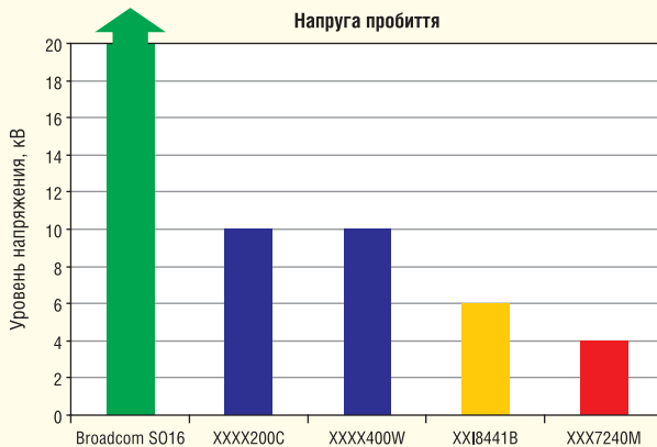
Рис. 5. Оптичні ізолятори набагато стійкіші до стрибків напруги, ніж ізолятори, створені з урахуванням інших технологій
