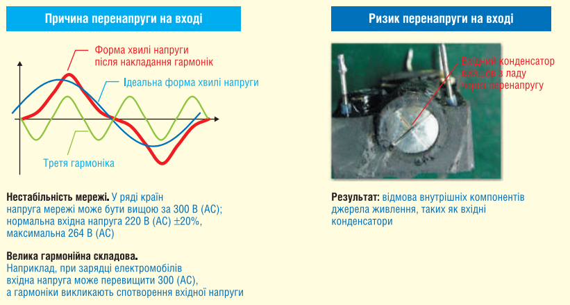
Рис. 4. Вплив нестабільності електромережі на елементи блоку живлення, причини та наслідки
