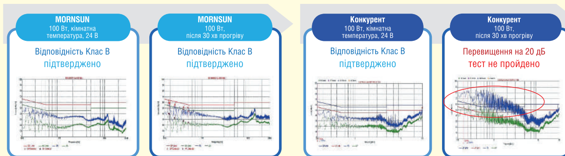
Рис. 7. Блоки живлення компанії MORN SUN показують стабільні характеристики кондуктивних електромагнітних перешкод як при кімнатній, так і за високої температури
