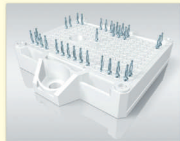
Рис. 5. «Розділена» топологія ANPC та конструктив SEMITOP E2. Компоненти, що утворюють контур комутації, розташовані в одному корпусі
