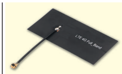
Рис. 2. Антена 2/3/4 G Quectel YF0006AA на гнучкій друкованій платі [8]
