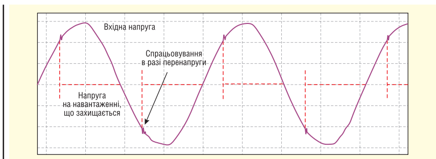
Рис. 4. Часова діаграма роботи універсального захисту під час стрибків напруги в мережі змінного струму
