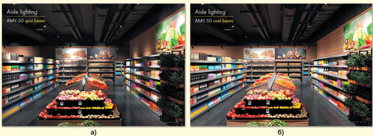
Рис. 2. Різниця в освітленні при використанні точкових та поздовжніх лінз AMY 50 однакової кількості
