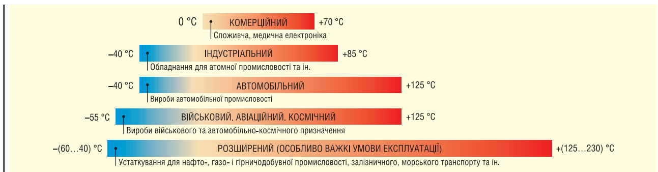
Рис. 1. Температурні діапазони роботи електронної апаратури
