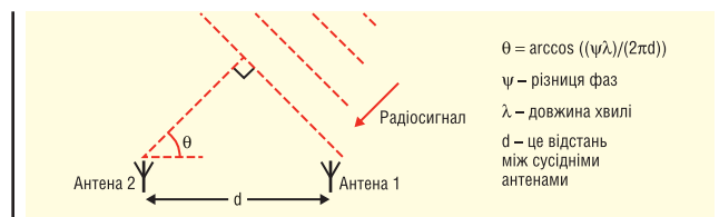
Рис. 3. Використання різниці фаз для обчислення кута прибуття. Адаптовано з Bluetooth SIG
