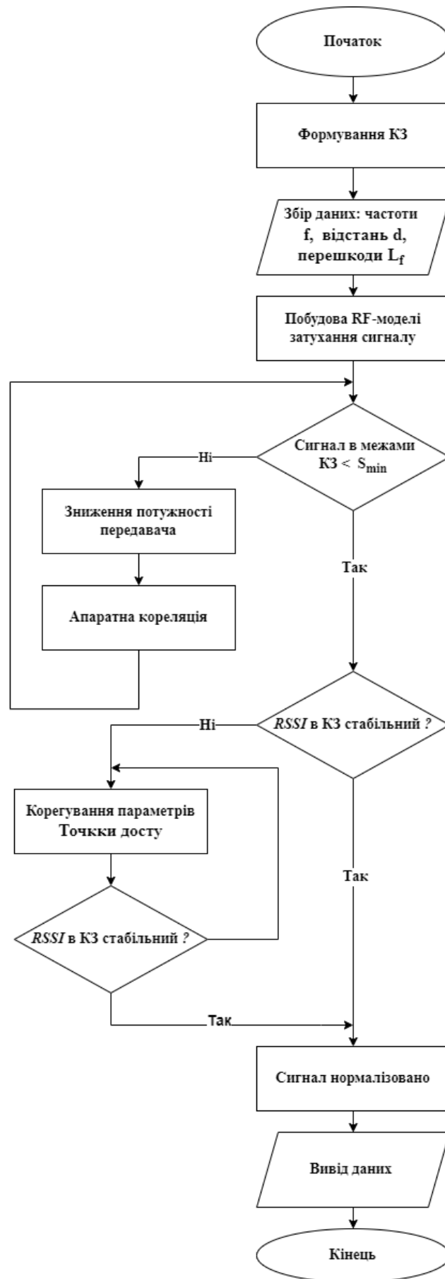
Рисунок 2.1 – Блок-схема алгоритму нормалізації
