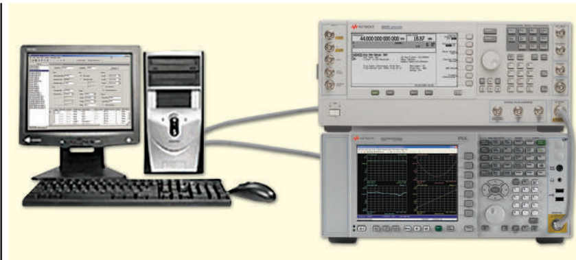
Рис. 10. Цифрові попередні спотворення за допомогою генератора сигналів серії PSG компанії Keysight
