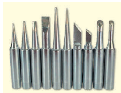
Рис. 3. Жала з різними типами робочих поверхонь
