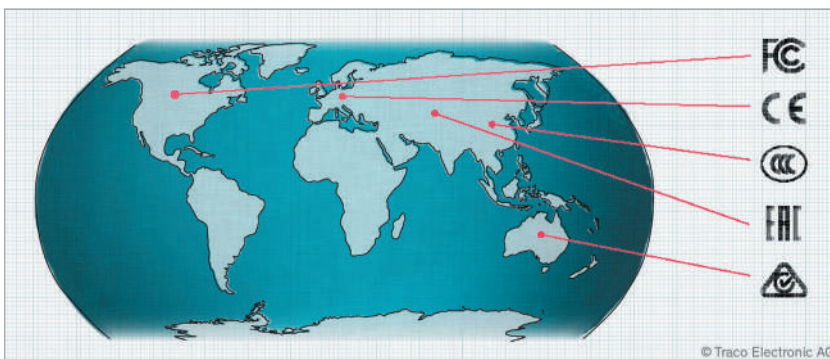
Рис. 3. Незважаючи на те, що існують загальні обмеження на електромагнітну сумісність і методи тестування, інженери повинні знати про відмінності, щоб досягти відповідності вимогам національних ринків
