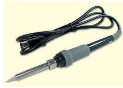
Рис. 2. Приклад паяльника із зручною ручкою, яку можна замінити
