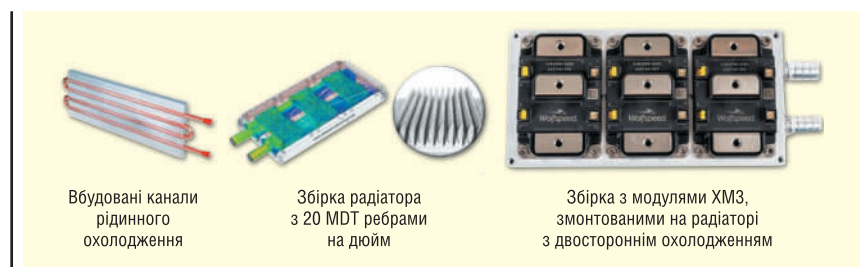
Рис. 3. Wolfspeed використовує радіатор із технологією мікродоформатії MDT від WIELAND, що має 20 ребер на дюйм (у стандартних радіаторів 12 ребер на дюйм), що забезпечує зниження теплового опору і рівномірне охолодження
