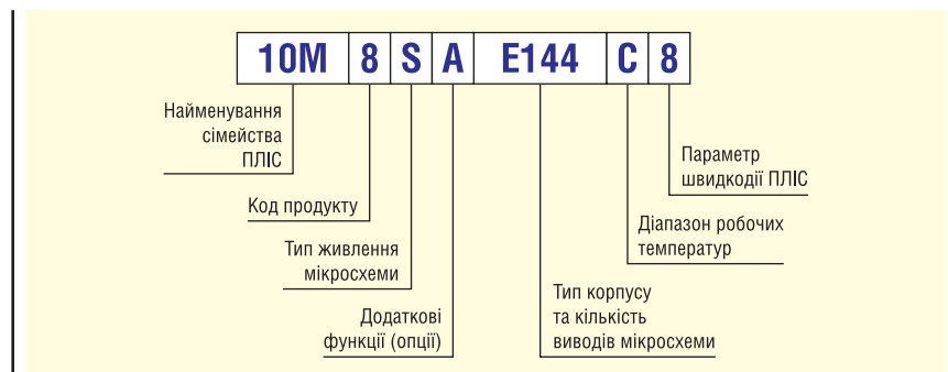
Рис. 2. Структура найменування ПЛІС сімейства MAX10
