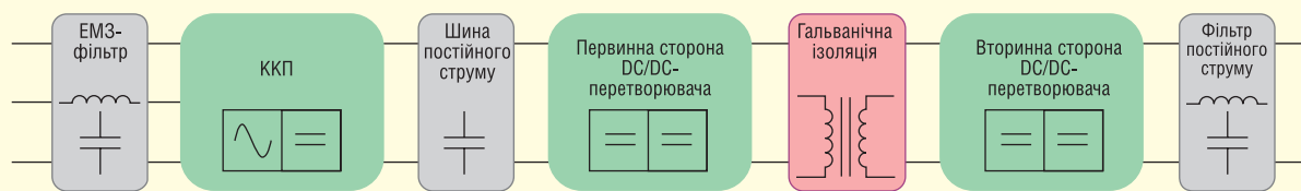
Рис. 1. Стандартна топологія зарядного субмодуля з номінальною потужністю 15–40 кВт
