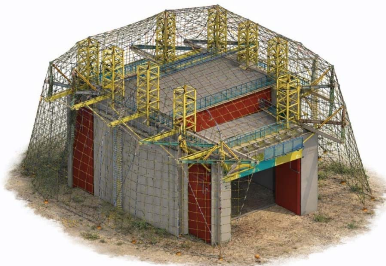
Рис. 2. Модель маскувального антидронового каркасно-сітчастого укриття над захищеним об'єктом Джерело: побудовано авторами в середовищі SolidWorks
