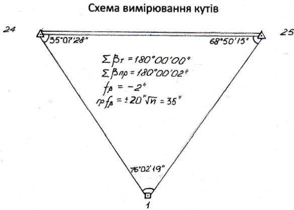
Рисунок 1. Схема до тренувальних вимірювань тренувального нівелювання прокладають хід за методикою III класу. Для нівелірного складають схему
