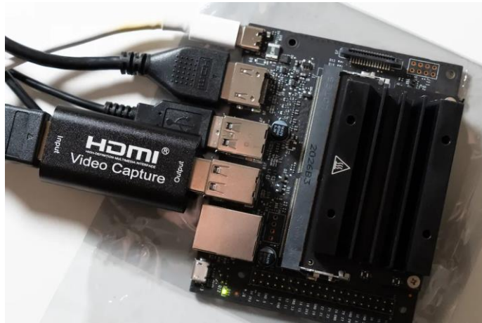
Рисунок 2 – Мікрокомп'ютер Jetson Nano з обчислювальною продуктивністю 472 GFLOPS
