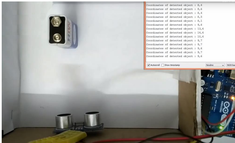
Рисунок 2 – Експериментальне дослідження периферійного пристрою на базі HC-SR04
