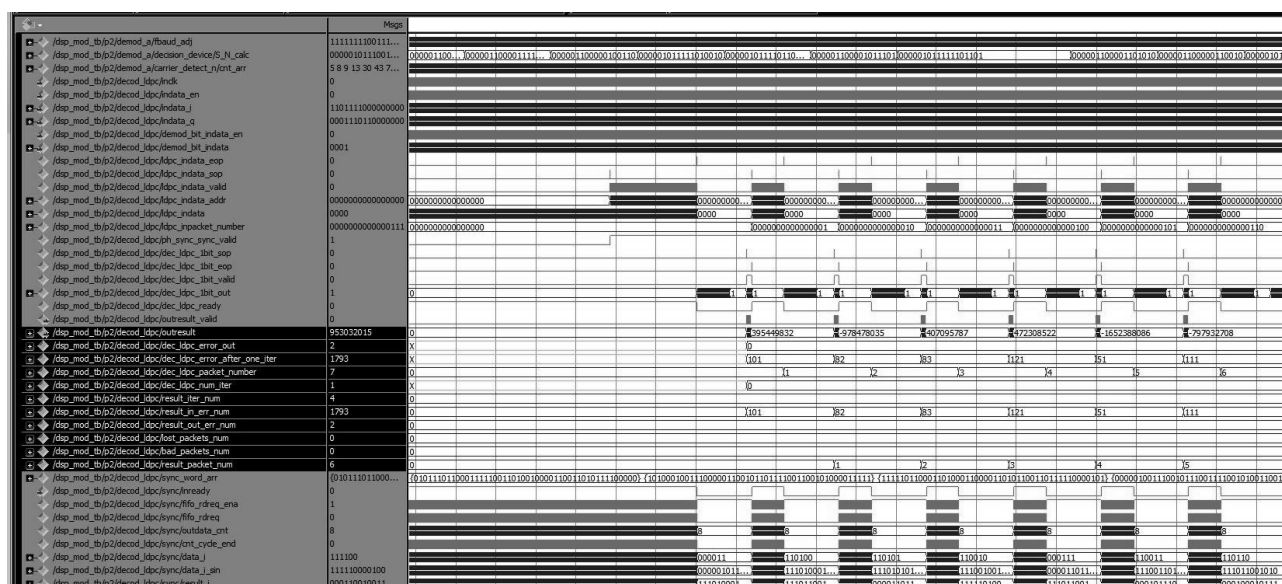
Рис. Б2. Моделювання роботи декодера з подвійним буфером
