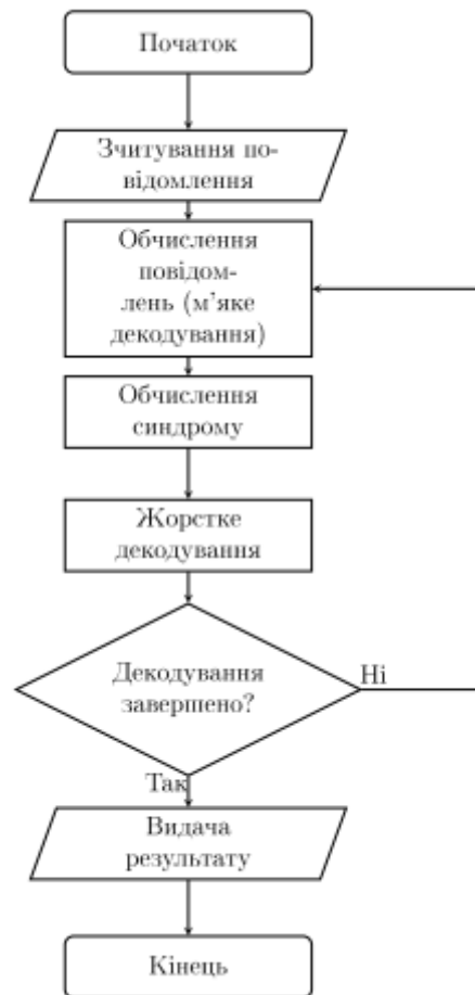
Рис. 2.1. Загальна блок-схема для алгоритму мінімальної суми
