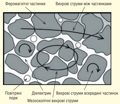
Рис. 9. Вихрові струми, що виникають у МПМ [30]
