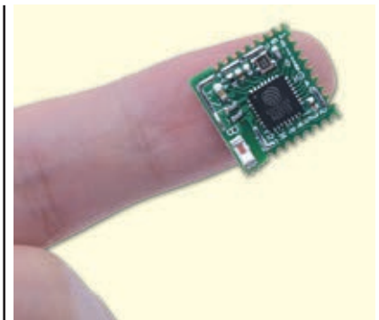
Рис. 1. Модуль Wi-Fi PSF-B85 від компанії ITEAD, що використовує мікросхему ESP8285 з високим ступенем інтеграції [3]
