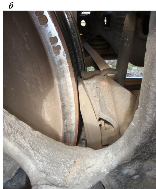
Рис. 1. Клинодуально зношені гальмові колодки: а – з верхньою шкідливою стертістю; б – за взаємодії верхнього кінця з поверхнею кочення колеса під час руху вагона
