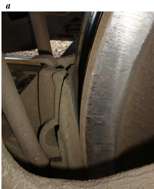
Рис. 1. Клинодуально зношені гальмові колодки: а – з верхньою шкідливою стертістю; б – за взаємодії верхнього кінця з поверхнею кочення колеса під час руху вагона
