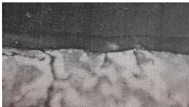
Рис. 4. Мікроструктура чавуну з покриттям
