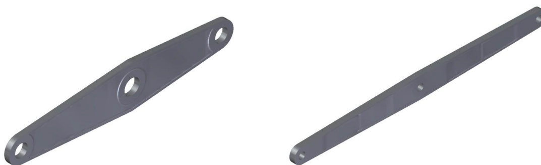
Рис. 7. Результат удосконалення горизонтального важеля в програмному комплексі Solid Edge ST10 зі зменшенням маси на 30 %
