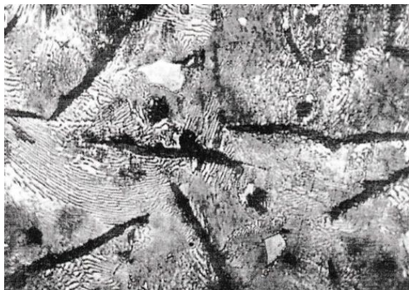
Рис. 2. Мікроструктура фрикційних клинів, виготовлених із чавуну марки СЧ-35
