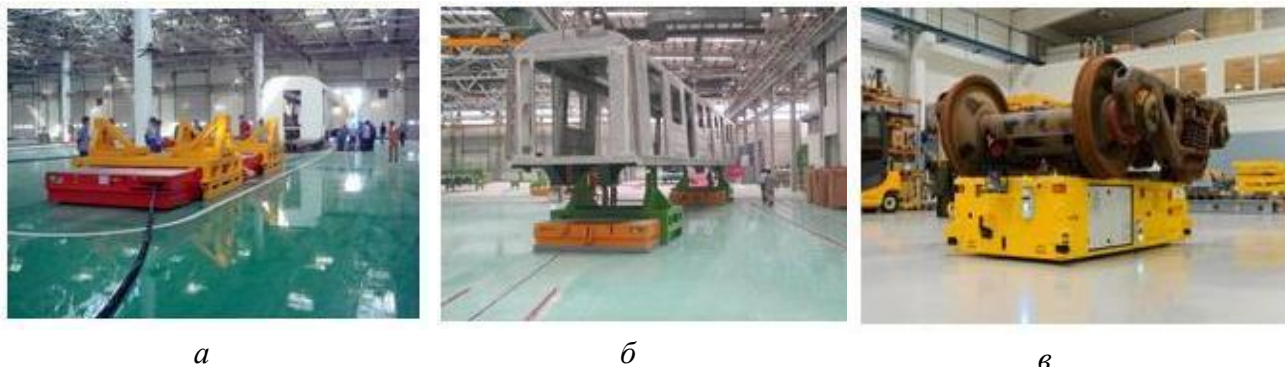
Рис. 1. Автоматизація транспортування на базі повітряної подушки: а – транспортер на повітряній подушці; б – залізничний вагон; в – візок
