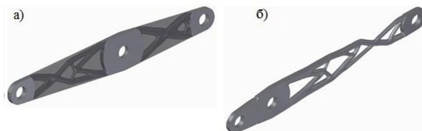
Рис. 1. Результат оптимізації важелів ГВП вагона–хопера в програмному комплексі Solid Edge ST10: а) нахилений важіль; б) вертикальний важіль
