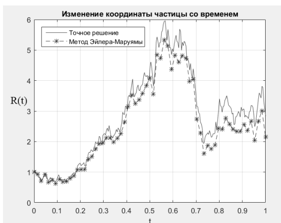
Рисунок 3 – Моделювання траєкторії руху БПЛА: точне рішення за методом БШ (суцільна лінія) та апроксимація за методом ЕМЛ (штрихова лінія із зірочками)
