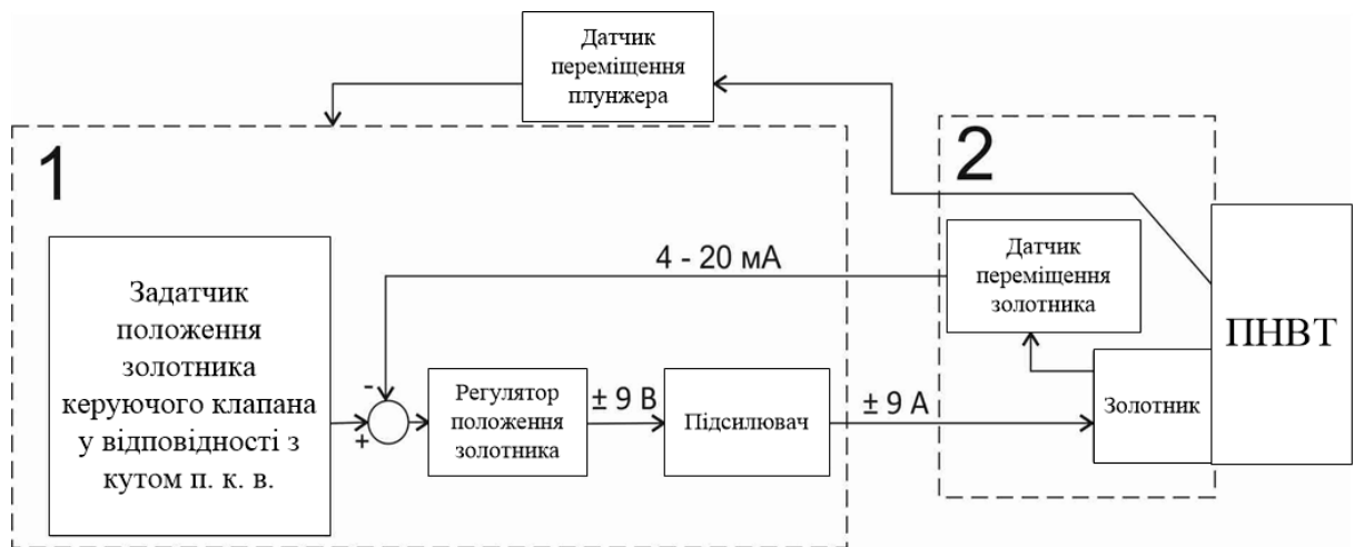
Рис. 1.6. Система управління пропорційним швидкодіючим клапаном: 1 - блок управління циліндром, 2 - пропорційний клапан, ПНВД - паливний насос високого тиску
