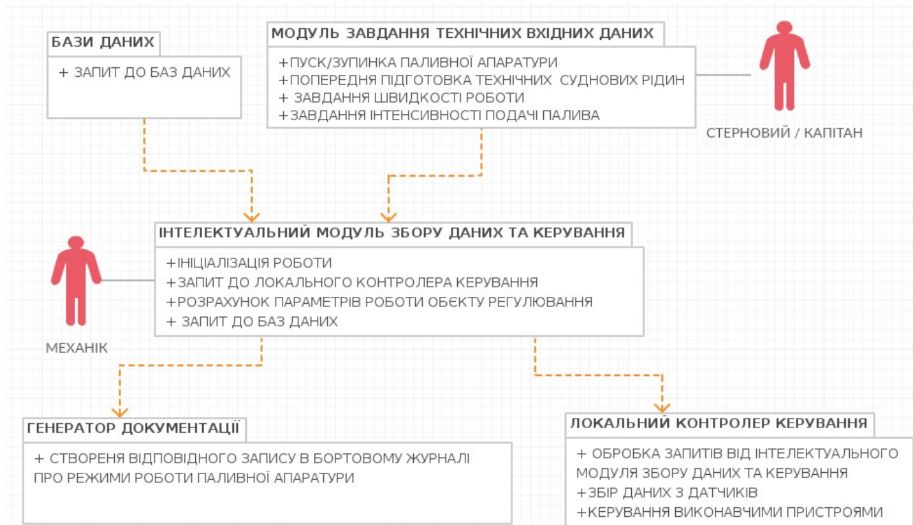
Рисунок 2.6 – Діаграма класів узагальненої системи автоматичного визначення та регулювання реологічних характеристик суднових технічних рідин
