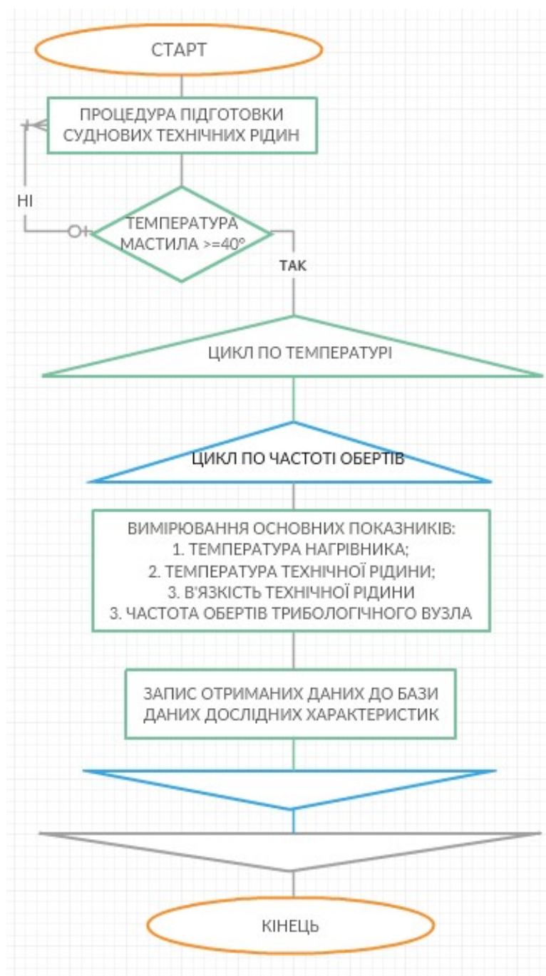
Рисунок 2.10 – Блок-схема алгоритму роботи лабораторної комп'ютерної системи визначення реологічних характеристик
